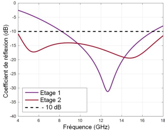
Figure 5. Coefficient de réflexion après le 1<sup>er</sup> et le 2<sup>nd</sup> étage de l'absorbant SAFASNAV.
