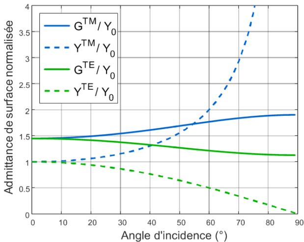
Figure 8. Evolution de la partie réelle de l'admittance de l'absorbant à 9.8 GHz en fonction de l'angle d'incidence pour les polarisations TE et TM.
