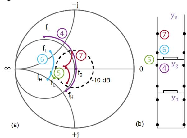
Figure 4. (a) Admittance du 2<sup>nd</sup> étage couche par couche. Les cercles correspondent aux admittances au niveau des couches représentées sur b). ④ est l'admittance de l'étage 1, ⑤ est l'admittance de la grille résistive seule en espace libre, ⑥ est la somme de ④ et ⑤, et ⑦ est l'admittance totale du 2<sup>nd</sup> étage.
