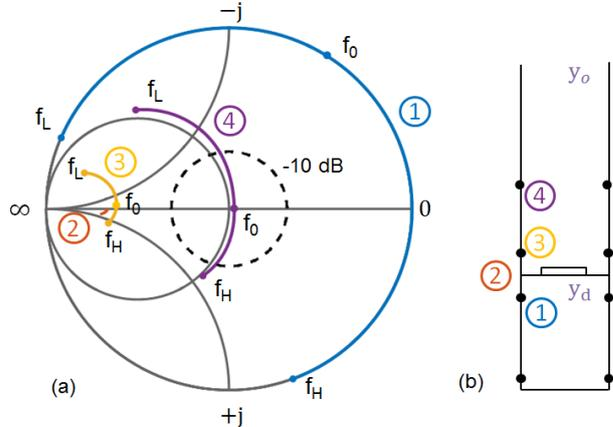
Figure 3. (a) Admittance du 1<sup>er</sup> étage couche par couche. Impédance de normalisation = 377 Ohms. Les cercles correspondent aux admittances au niveau des couches représentées sur b). ① est l'admittance du substrat court-circuité, ② est l'admittance du damier seul en espace libre, ③ est la somme de ① et ②, et ④ est l'admittance totale du 1<sup>er</sup> étage.
