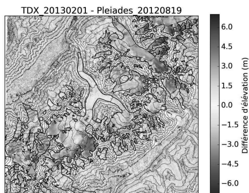
Figure 8 : Différence entre le MNE TDX 2013/02/01 et Pléiades 2012/08/19. Le sommet du Mont Blanc (4810 m a.s.l.) est marqué par un triangle jaune. L'arrière-plan est un relief ombragé du MNE Pléiades.
