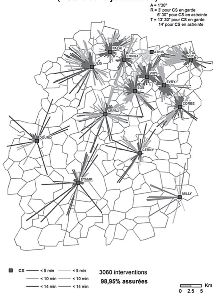
**Figure 8: carte d'étude pour aide à la décision montrant le résultat du modèle de couverture hybride d'ArcGIS pour la localisation de 14 moyens élévateurs aériens afin de couvrir un maximum d'interventions dans les délais impartis (oursins) (source : SDIS 91)**
