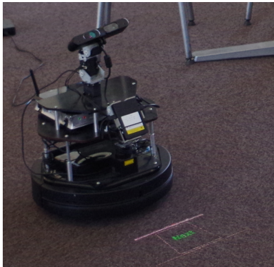
FIGURE 2 – EMOX : Un turtle-bot composé d'un appareil photo, télémètre laser, pico projecteur, microphone et haut-parleur.
