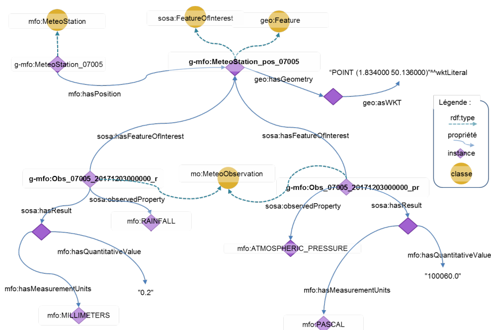
FIGURE 5 – Instanciation du sous-modèle "mfo" : le "feature of interest" des observations d'une station météo est le lieu où se trouve la station.
