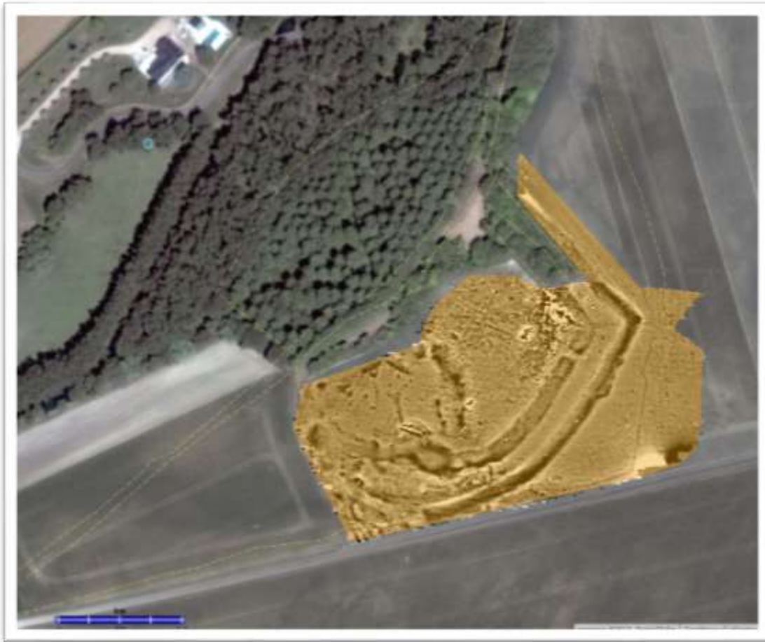
Fig. 6 Cartographie magnétique (zones en marron) incrustée sur une photographie aérienne sur le site de Meunet-Planches (Indre) : mise en évidence de deux fossés et d'une porte sur un site interprété comme une ferme fortifiée de l'âge du fer (demande K. Gruel et O. Buchenschutz, ENS Paris, Programme Celsephys, prospection Geocarta avec l'AMP).
