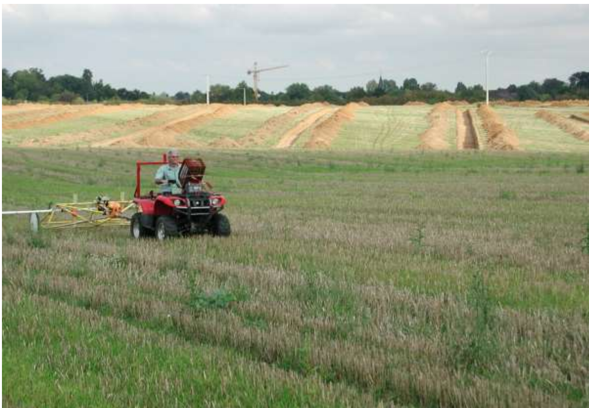
Fig.2 Mesure géophysique en continu (EM31 Geonics) sur le projet d'aménagement de Vémars ( Val d'Oise). En arrière-plan des tranchées mécaniques de diagnostic. Geocarta©
