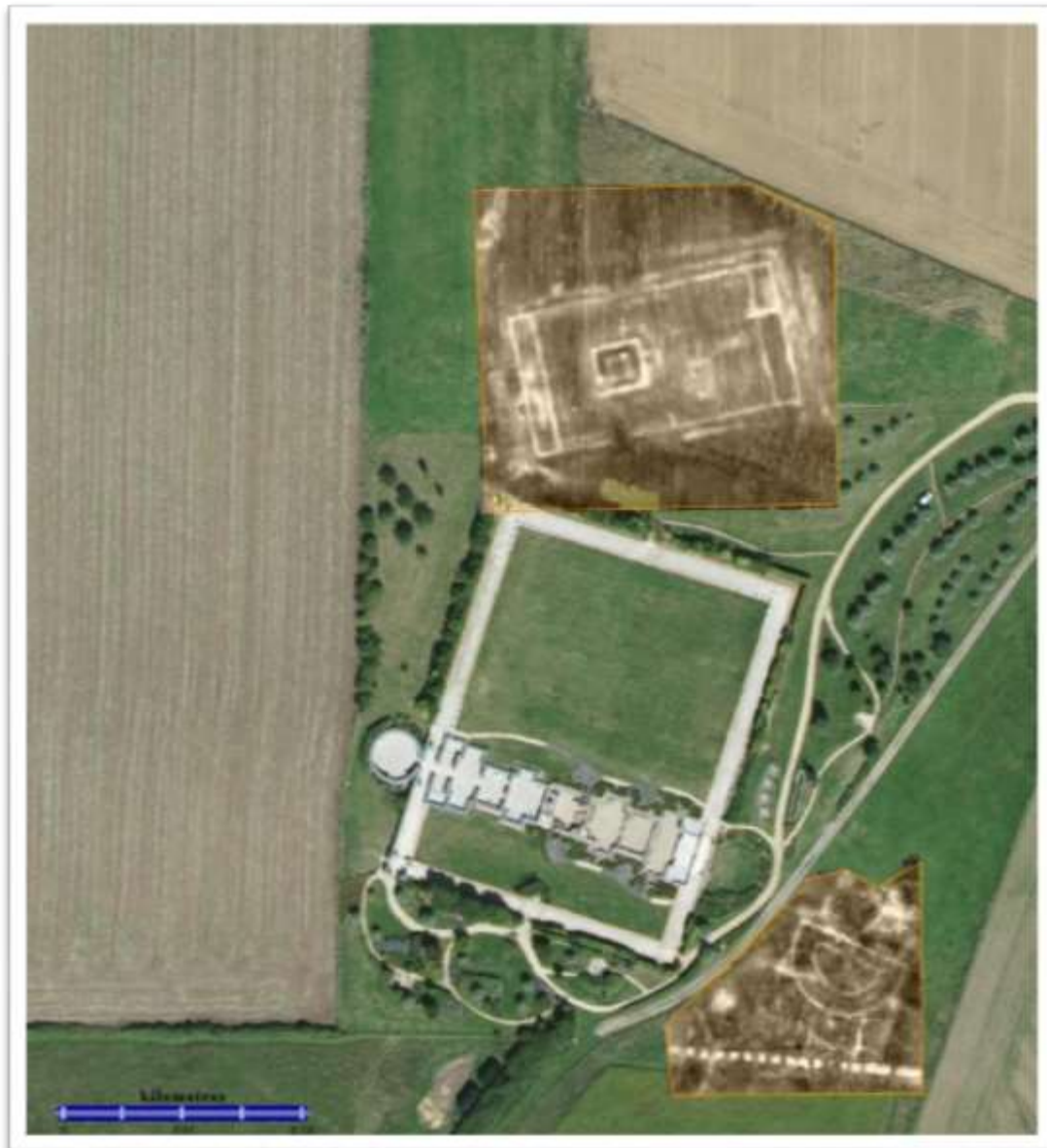
Fig. 4 Cartographies électriques (zones en noir et blanc) pour une profondeur moyenne de 1m incrustées sur une photographie aérienne de part et d'autre des thermes gallo-romains du site du Vieil-Evreux (Eure) : mise en évidence au Nord des murs d'un temple celtique et au Sud-Est des piliers d'un aqueduc relié à une structure hémisphérique interprétée comme un macellum ( demande Laurent Guyard, CG Eure, prospection manuelle Terra Nova et ARP® Géocarta).
