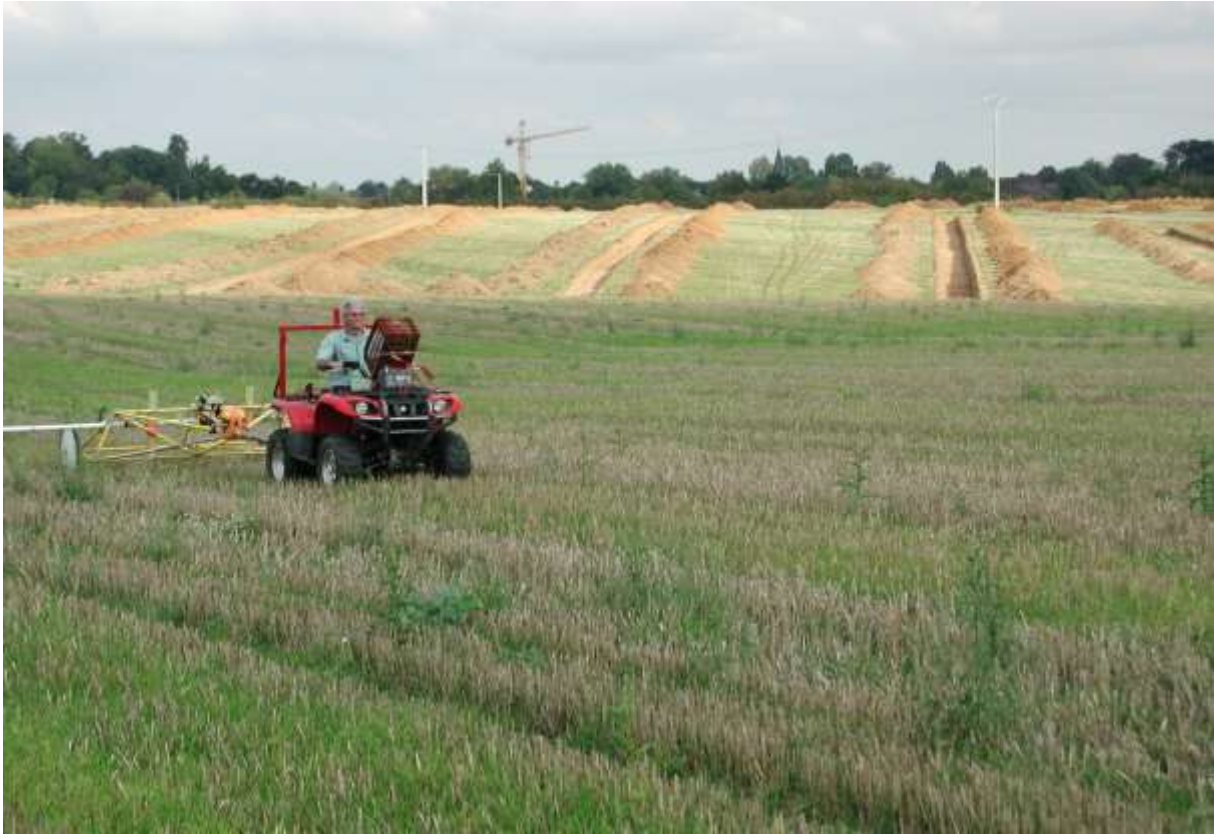
Fig.2 Mesure géophysique en continu (EM31 Geonics) sur le projet d'aménagement de Vémars ( Val d'Oise). En arrière-plan des tranchées mécaniques de diagnostic. Geocarta©
