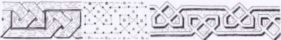
Fig. 99 - Treillage; transformation du réseau et épure de l'entrelacs; entrelacs sculptés sur les chapiteaux couronnant les colonnes du mihrab de la mosquée de Sidi-Boumediène (Tlemcen).
