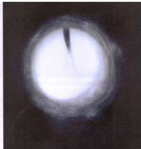
Figure 49 : Radiographie, vue de dessus montrant le morceau de bois fissuré
