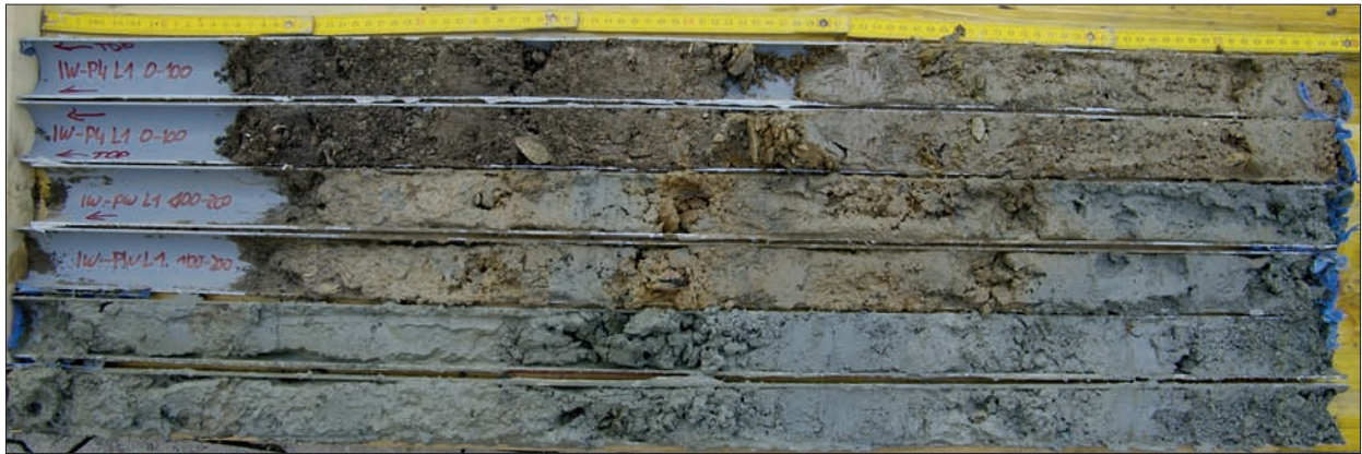
Abb. 11 Mendig, »Im Winkel«, Bohrung P4-L1 – geöffnete Halbschalen eines 3 m tiefen Bohrprofils aus dem vermuteten Rückhaltebecken. Deutlich ist eine Abfolge von tonigen bis kiesigen Lagen zu erkennen. Das gröbere Material weist auf stärkere Abflussereignisse hin. – (Foto 1.7.2010).
