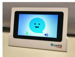
Le dispositif matériel "LinTO" inclut carte CPU de type Raspberry Pi, écran tactile, haut-parleurs, matrice de microphones et suivant les configurations, une caméra 360°. Il est complété par une
