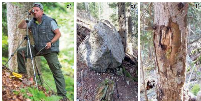
Fig. 1 Le terrain étudié est situé dans les Alpes françaises (a), sur les contreforts du Vercors, à 40 km au sud-ouest de Grenoble (b). Le terrain d'étude – délimité par un polygone rouge (c) – a fait l'objet d'un inventaire forestier à l'aide d'un minithéodolite (d). Des blocs de 1 m 3 ont pu être observés sur le bas du versant ainsi que des traces de blessures sur les arbres (f). Photo d) : Sébastien De Danieli
