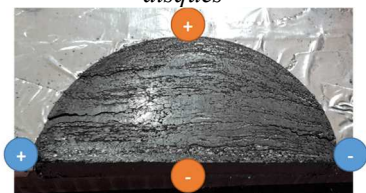
Figure 5: Demi-échantillon comprimé et position des électrodes de l'ohmmètre
