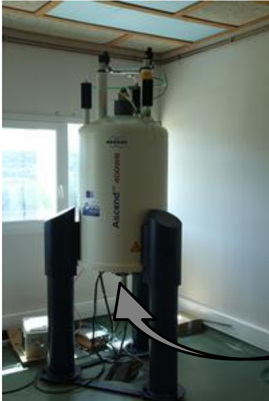
9.4T Bruker Ascend 400WB Ø 30mm 1 H volume coil
