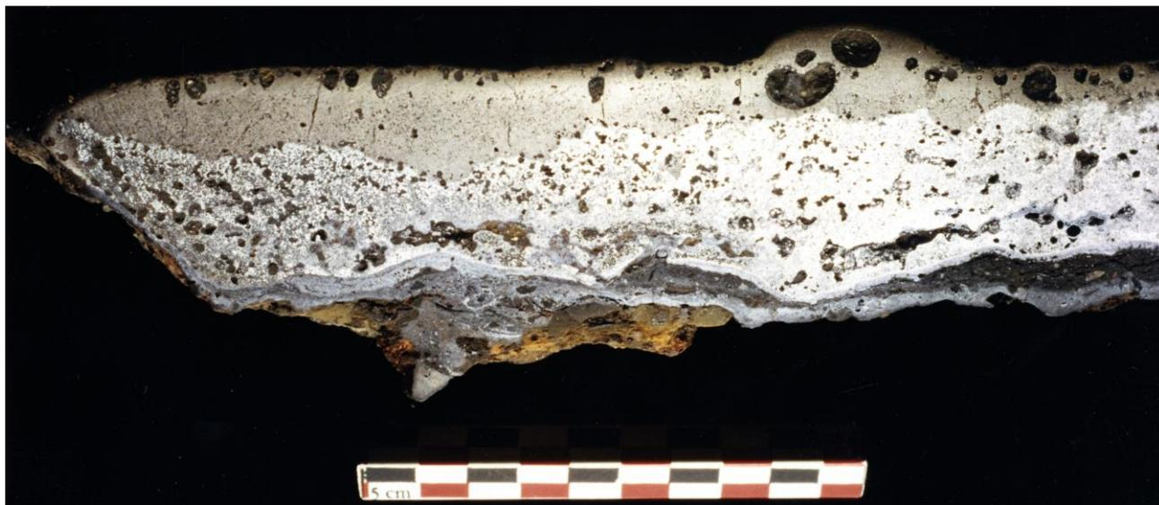
Illust 21 – résidu métallique stratifié par densité, qui remplissait un bassin d’env 30 cm de diamètre ; section sciée ; fouille de la fonderie de plomb et d’argent de Lauterupt près de Ban-de-Laveline (Lorraine), 1995. Photo P. Fluck
