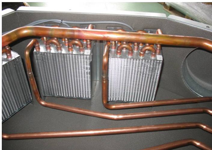
Figure 6.19 Vue des batteries des voies 1 et 2 du nouveau prototype
