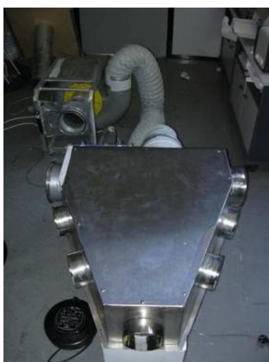
Figure 6.8 Vue du prototype à 5 piquages associé au Perméascope ®
