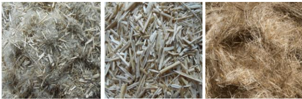
Figure 2. Différentes vues de fractions végétales obtenues après les étapes d'extraction des fibres
