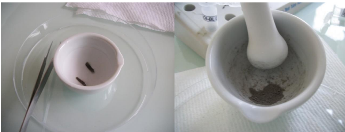
Figure 17 : Mortier et pilon pour broyer les échantillons
