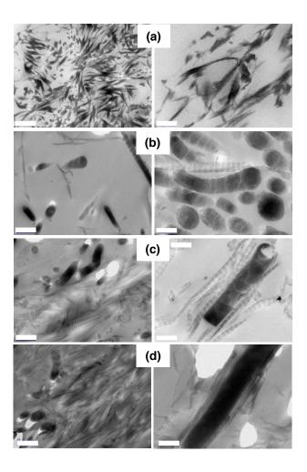
**Fig. 4** TEM of (a) 20 mg.mL<sup>-1</sup> collagen. (b) 10 mg.mL<sup>-1</sup> collagen, 120 mg.mL<sup>-1</sup> SiNRs. (c) 20 mg.mL<sup>-1</sup> collagen, 60 mg.mL<sup>-1</sup> SiNRs. (d) 30 mg.mL<sup>-1</sup> collagen, 30 mg.mL<sup>-1</sup> SiNRs. Scale bar: left-hand column: 500 nm; right-hand column: 200 nm
