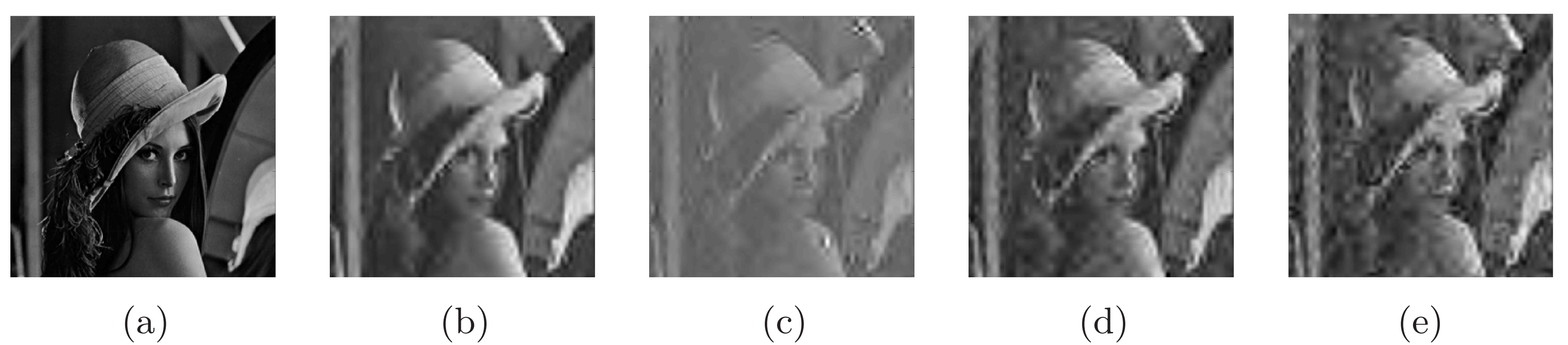
FIGURE 2: Comparaison des différentes méthodes d'acquisition de mesures mono-pixel. a) Vérité terrain, b) séparation de motifs, c) factorisation inexacte [4], d) factorisation proposée avec batches, e) factorisation proposée sans batch. Ces résultats ont été obtenus avec \alpha = 20000 photons/s, N_0 = 2100 photons/s, and \Delta t = 0.1 s, et un bruit de Poisson.
