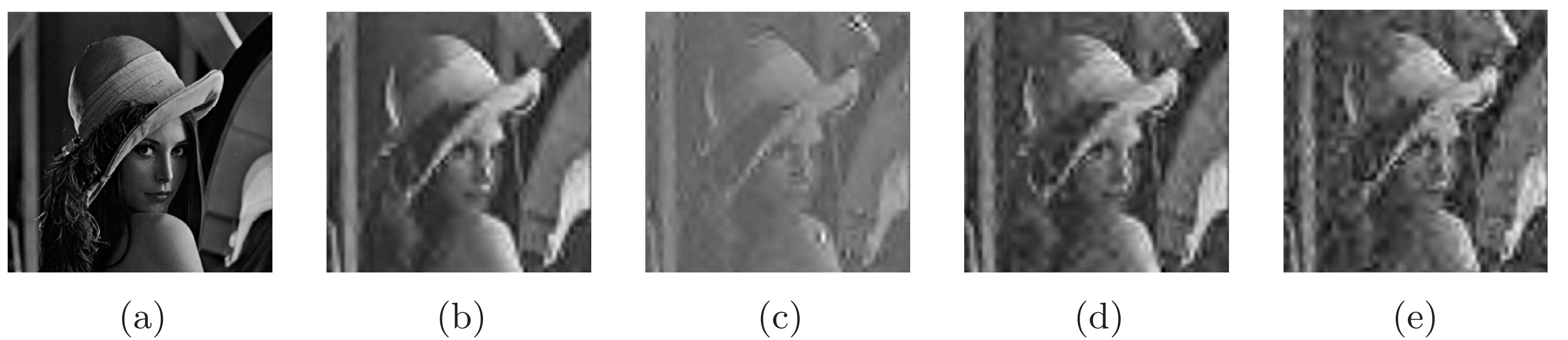
FIGURE 2: Comparaison des différentes méthodes d'acquisition de mesures mono-pixel. a) Vérité terrain, b) séparation de motifs, c) factorisation inexacte [4], d) factorisation proposée avec batches, e) factorisation proposée sans batch. Ces résultats ont été obtenus avec \alpha = 20000 photons/s, N_0 = 2100 photons/s, and \Delta t = 0.1 s, et un bruit de Poisson.
