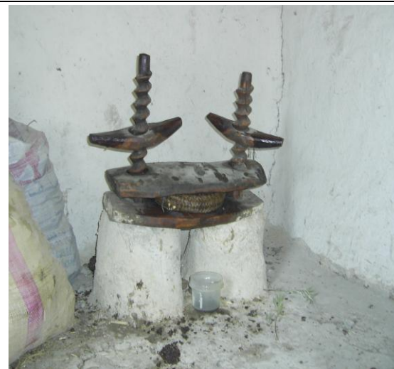
Photo 3 : Petite presse en bois à usage domestique pour préparer Alouana
