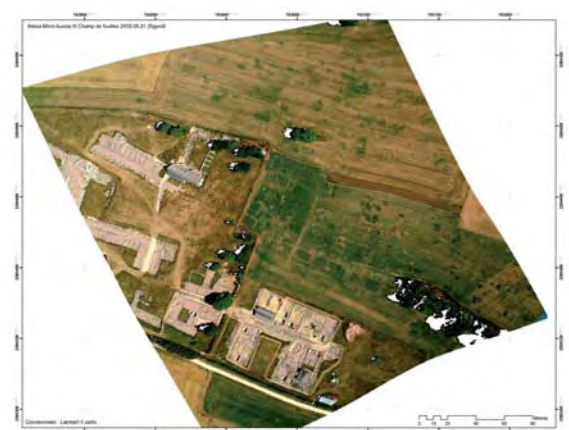
Fig. 38 : Géorectification par interpolation de fonction spline de trois clichés aériens du centre ville d'Alésia.
