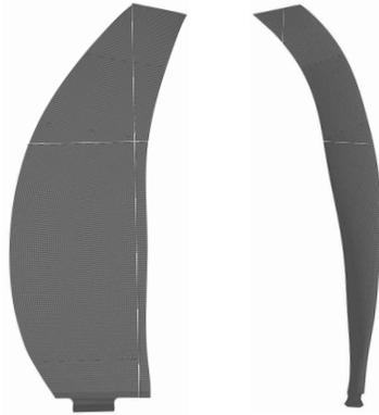
Fig. 2: FINITE ELEMENT MODEL OF THE INDUSTRIAL BLADE
