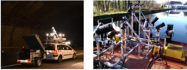
FIGURE 2 – Système de prises de vues du Cerema monté sur une automobile (à gauche) ou un bateau (à droite) pour l'acquisition d'images en tunnels routiers ou navigables
