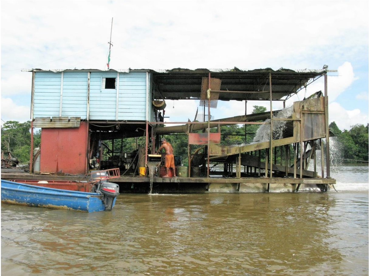
26. Barge pour l'exploitation de l'or sur le Maroni, en Guyane, photo P. Fluck
