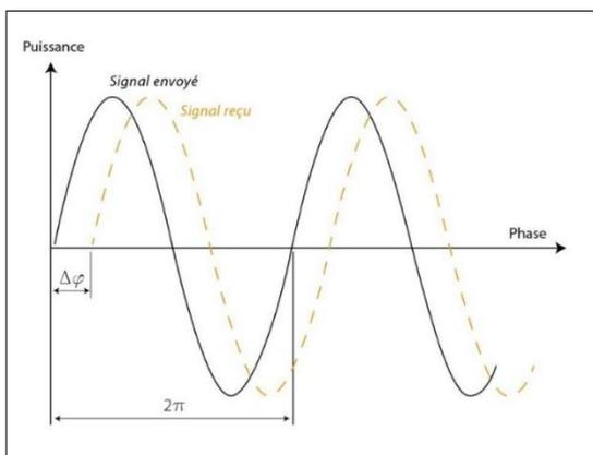
Figure 12 - Calcul du décalage de phase (source Hyun-Jae Yoo, 2011)  $\Delta\varphi$  : décalage de phase (radian),  $S_{\text{émis}}$  : signal envoyé ( $\cos(\omega t)$ ),  $S_{\text{reçu}}$  : signal reçu ( $\cos(\omega t + \Delta\varphi)$ ),  $T = 1/f$  : période (s),  $\omega$  : Pulsation (rad/s)
