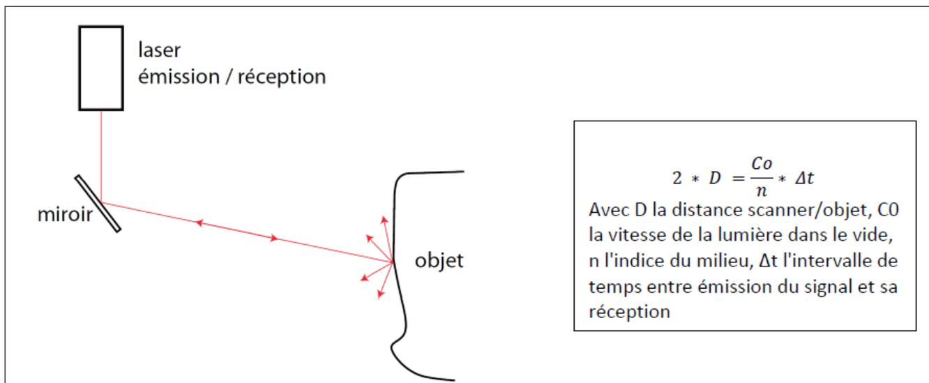
Figure 14 - Fonctionnement d'un scanner laser à impulsion
