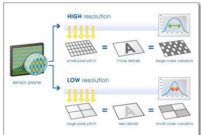
Figure 5 - Taille du pixel et ratio signal/bruit
