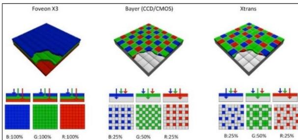
Figure 4 Les différentes technologies de capteur photographique
