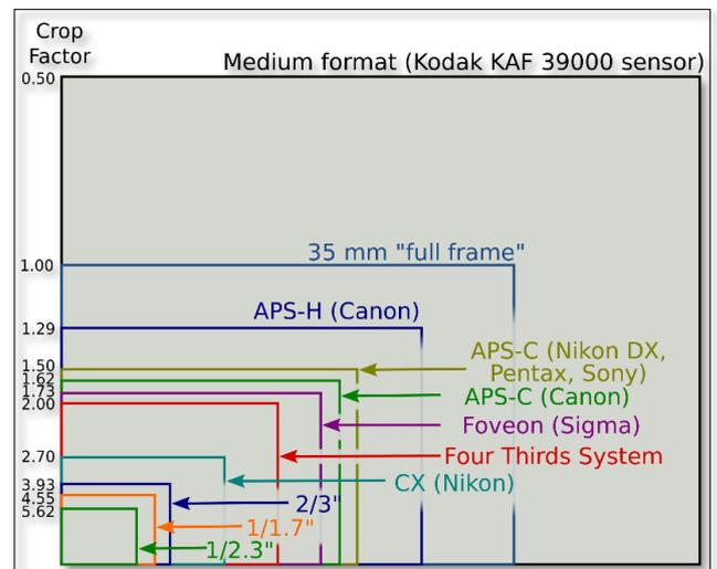
Figure 3 - Schéma taille des capteurs et du « crop factor »
