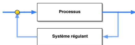
FIG. 1 – Représentation d'une boucle de rétroaction
