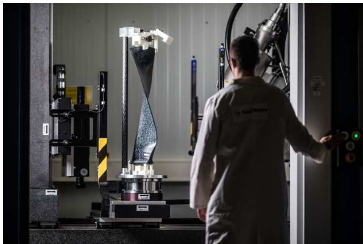
FIGURE 2 – Tomographie d’une aube LEAP-1A (Copyright Adrien Daste / Safran)
