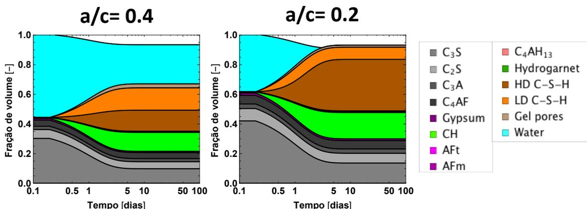
Figura 1 – Evolução das frações de volume das fases para um sistema com a/c inicial de 0.4 e 0.2
