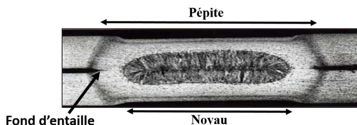
FIGURE 1 – Section d'un PSE utilisé dans l'industrie automobile
