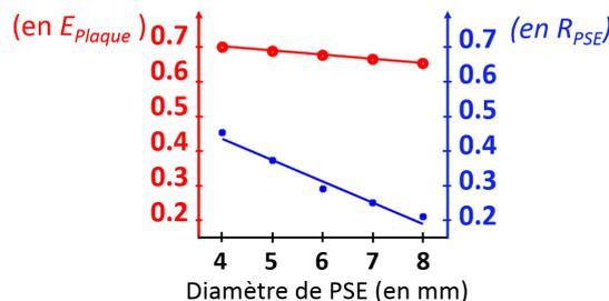
FIGURE 9 – Évolution de la distance de passage du seuil à 3 % exprimée en "épaisseur de plaque" :  $E_{plaque}$  et en "Rayon de PSE", en fonction du Diamètre de PSE. Les points sont interpolés linéairement. La distance est prise depuis le fond d'entaille. L'épaisseur de plaque est ici égale à 1.3 mm.
