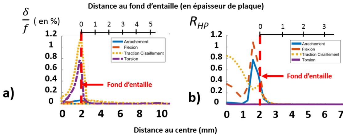
FIGURE 8 – a) Rapport (en %) entre la quantité d'intérêt cinématique  $\delta$  et la flèche de l'éprouvette, pour chaque déformée ; b) Amplitude de la quantité  $R_{HP}$  pour chaque déformée. a) et b) : les quantités sont évaluées pour tous les cas de chargement unitaires dans la configuration particulière d'épaisseur de plaque 1.3 mm et de diamètre de PSE 4 mm. En abscisse, la distance radiale est exprimée en millimètres depuis le centre, et en "épaisseur de plaque" depuis le fond d'entaille.
