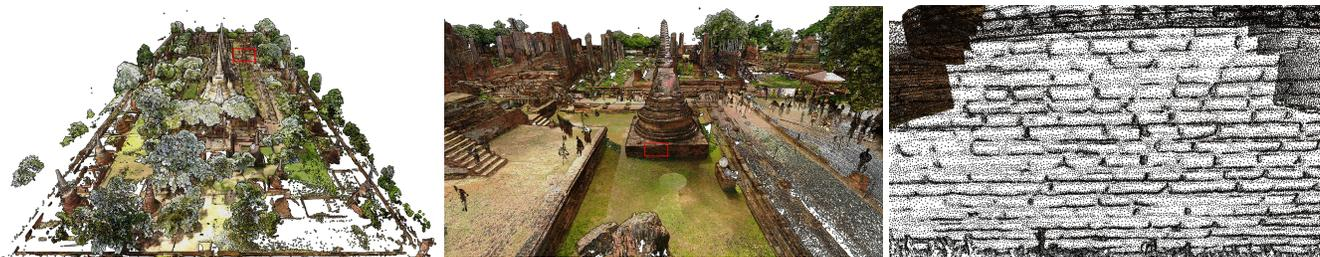
FIGURE 1 – Wat Phra Si Sanphet, à Ayutthaya (Thaïlande). 40 000m<sup>2</sup> rééchantillonnés avec notre méthode. La donnée initiale est composée de plus de 5 milliards de points provenant de 156 acquisitions. Cette version simplifiée contient environ 155 millions de points (2,8%), et préserve malgré tout les détails fins.
