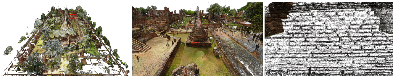
FIGURE 1 – Wat Phra Si Sanphet, à Ayutthaya (Thaïlande). 40 000m 2 rééchantillonnés avec notre méthode. La donnée initiale est composée de plus de 5 milliards de points provenant de 156 acquisitions. Cette version simplifiée contient environ 155 millions de points (2,8%), et préserve malgré tout les détails fins.
