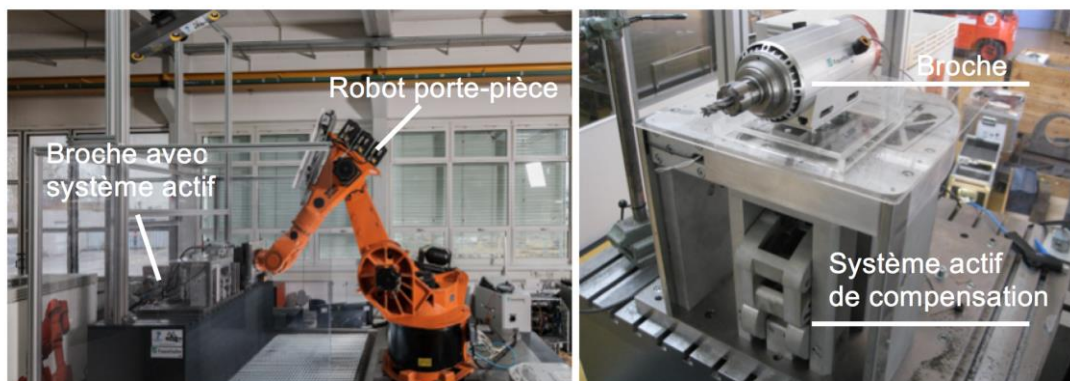
Figure 12 - Dispositif d'usinage robotisé avec porte-broche à actionnement piézoélectrique
