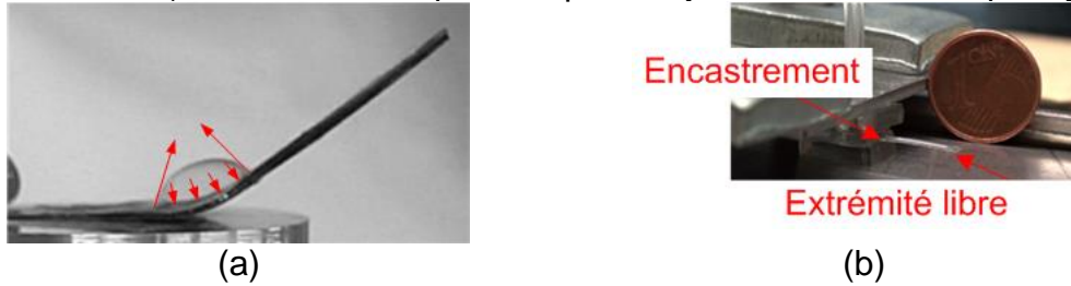
Figure 23 - Actionneurs de type ballon (a) localisés (d'après [26]); (b) distribués (Photo mise à disposition par Benjamin Gorissen, d'après [22]).
