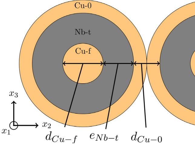
**Fig. 4.** Largeur théorique des canaux  $\delta$  : sur le Zoom 1,  $e_{Nb-t}$  désigne l'épaisseur des tubes de niobium,  $d_{Cu-f}$  le diamètre des filaments de cuivre,  $d_{Cu-0}$  la largeur des canaux de cuivre.
