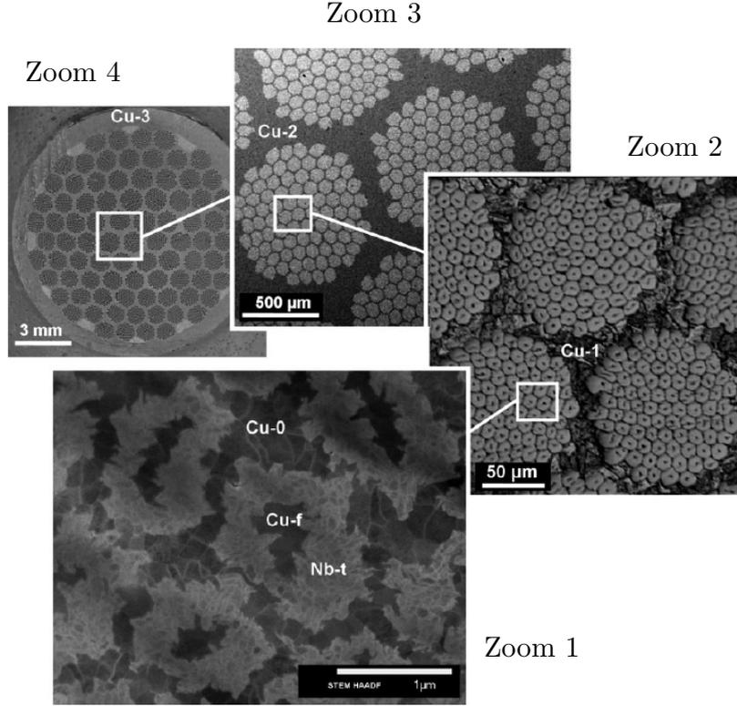
**Fig. 1.** Microstructure multi-échelle des conducteurs nano-composites Cu-Nb. Zoom 4, 3 et 2 : observations par Microscopie Électronique à Balayage (MEB), Zoom 1 : observation par Microscopie Électronique en Transmission (MET) [6, 7].
