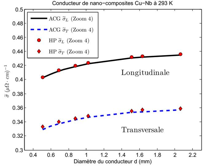
**Fig. 5.** Conductivités effectives longitudinale et transversale en fonction du diamètre du conducteur, pour les fils de nano-composites Cu-Nb sur le Zoom 4 (i.e. à l'échelle macroscopique) à 293 K, obtenues par le modèle Auto-Cohérent Généralisé (ACG, traits continus) et par Homogénéisation Périodique (HP, points).
