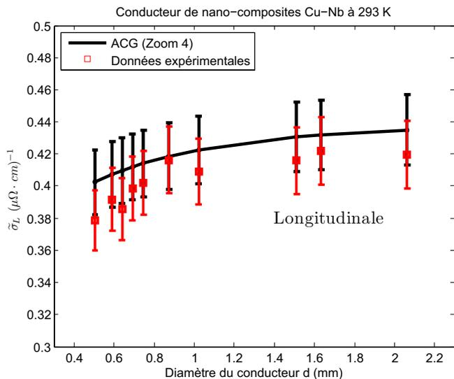
**Fig. 6.** Conductivité effective longitudinale obtenue avec le modèle ACG (Auto-Cohérent Généralisé, trait continu), et comparée aux données expérimentales (points), en fonction du diamètre du conducteur, pour les fils de nano-composites Cu-Nb sur le Zoom 4 (échelle macroscopique) à 293 K. L'incertitude sur la mesure de la conductivité des échantillons massifs ( $\sim 5\%$ ) entraîne une incertitude du même ordre sur les résultats du modèle ACG.
