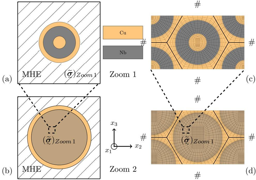
**Fig. 3.** Modélisation multi-échelle de la conductivité effective du Zoom 1 (a et c) au Zoom 2 (b et d). (a, b) : processus itératif par modèle Auto-Cohérent Généralisé (ACG); (c, d) : Homogénéisation Périodique (HP) avec les maillages de la méthode des éléments finis (MEF).
