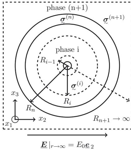
**Fig. 2.** Problème cylindrique  $n$ -phase (conduction électrique transversale).
