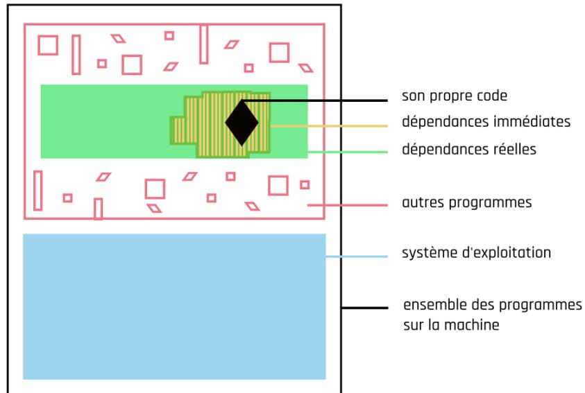
**FIGURE 16.1 :** Schéma des différents environnements logiciel
