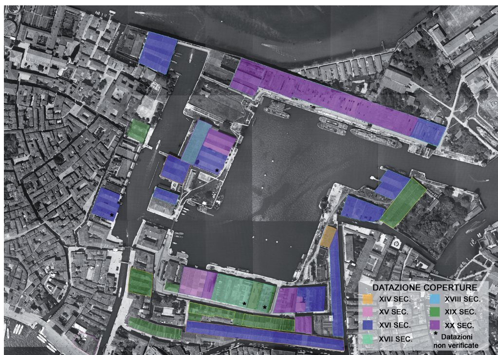
Fig. 6 – Les bâtiments de l’Arsenal de Venise : datations des fermes des toitures d’après les sources historiques (dessin Giulia Bettioli, in Menichelli, 2009).
