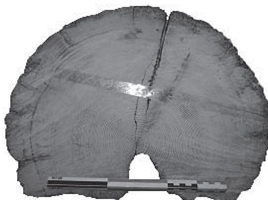
Fig. 13 – La panne faitière, marquée «XXVII», au deuxième plan sur la photographie de gauche, est située dans l'ombre au sommet de la cloison. Elle a été échantillonnée sous forme de section (0416601_54, photographie de droite). La panne au premier plan («XXVI») a été carottée mais n'est pas datée pour l'instant (clichés: L. Shindo).
