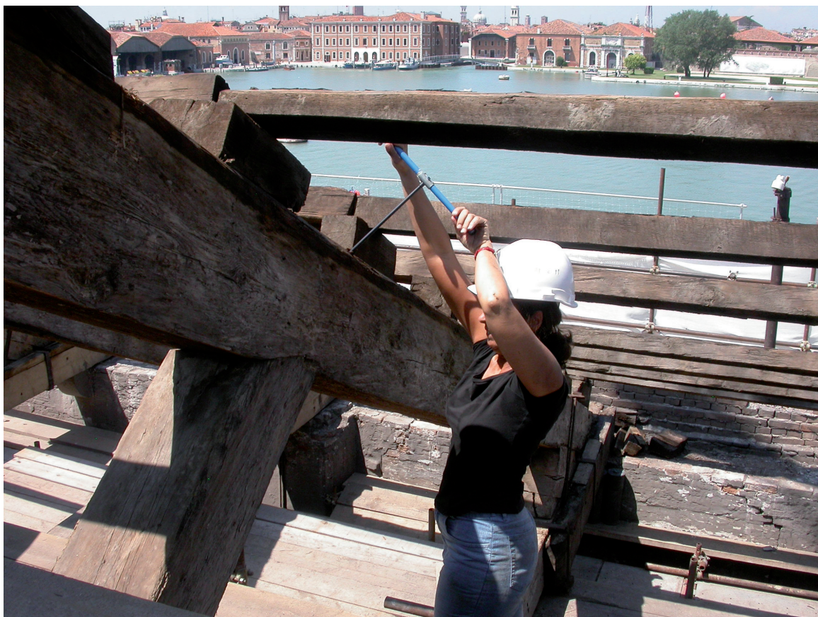
Fig. 7 – Arsenale – Isolotto: prélèvement avec la tarière de Pressler (photo: Dendrodata s.a.s.).
