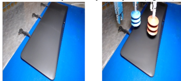
Détection de présence de pièce robuste Détection de présence problématique
