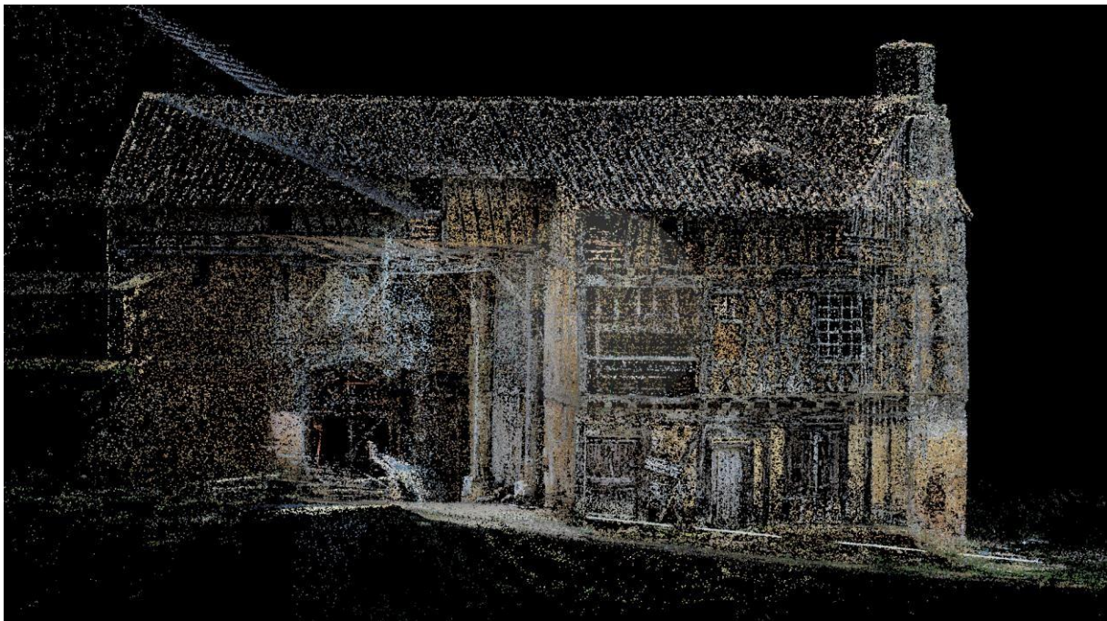
Figure 43 : Sainte Christie d'Armagnac - Mission du 22/11/18 – Nuages de points de liaison
