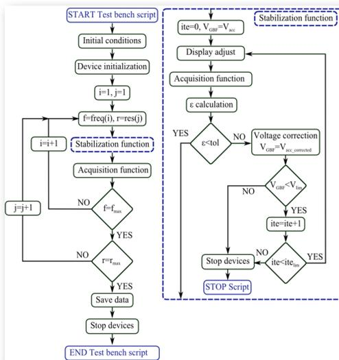
Solliciter le dispositif en fréquence et en résistance de charge à accélération constante
