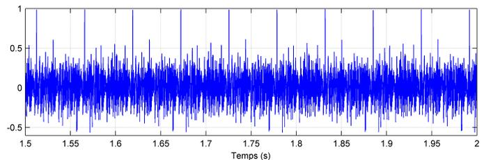
FIGURE 4 – Identification de l'émetteur par corrélation.
