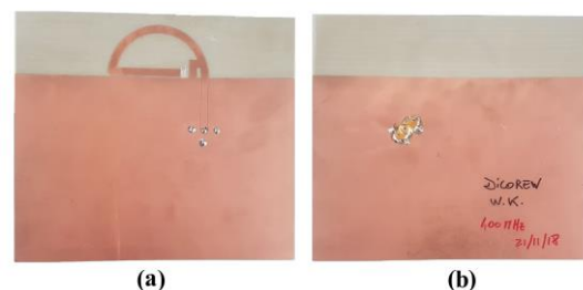
Figure 2. Antenne à caractériser, (a) vue de dessus, (b) vue de dessous.
