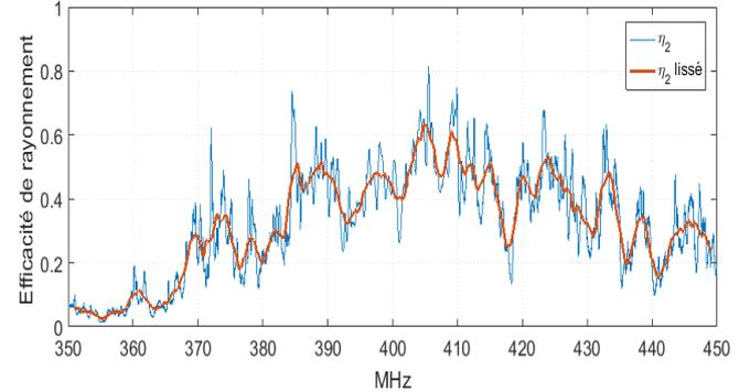
**Figure 8. Efficacité de rayonnement de l'antenne 2.**
