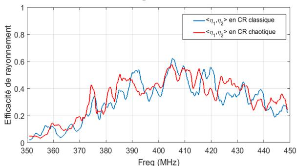
**Figure 11. Efficacité de rayonnement moyenne calculée dans les deux configurations de la CR.**
