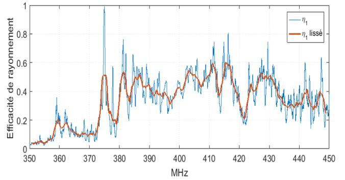
**Figure 7. Efficacité de rayonnement de l'antenne 1.**
