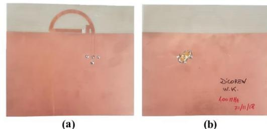
Figure 2. Antenne à caractériser, (a) vue de dessus, (b) vue de dessous.
