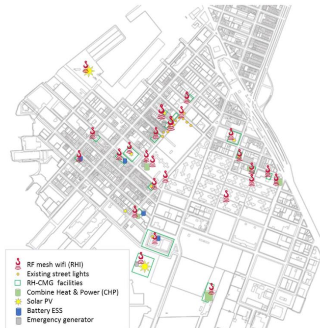
Figure 43. Les nœuds du réseau de la micro-grid =© Red Hook, NYSERDA.
