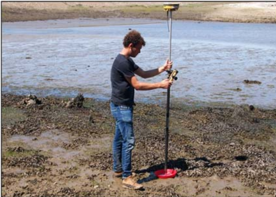
Figure 4. Position et relevé DGPS des cibles au sol sur le Sillon des Anglais le 20 juin 2018.
