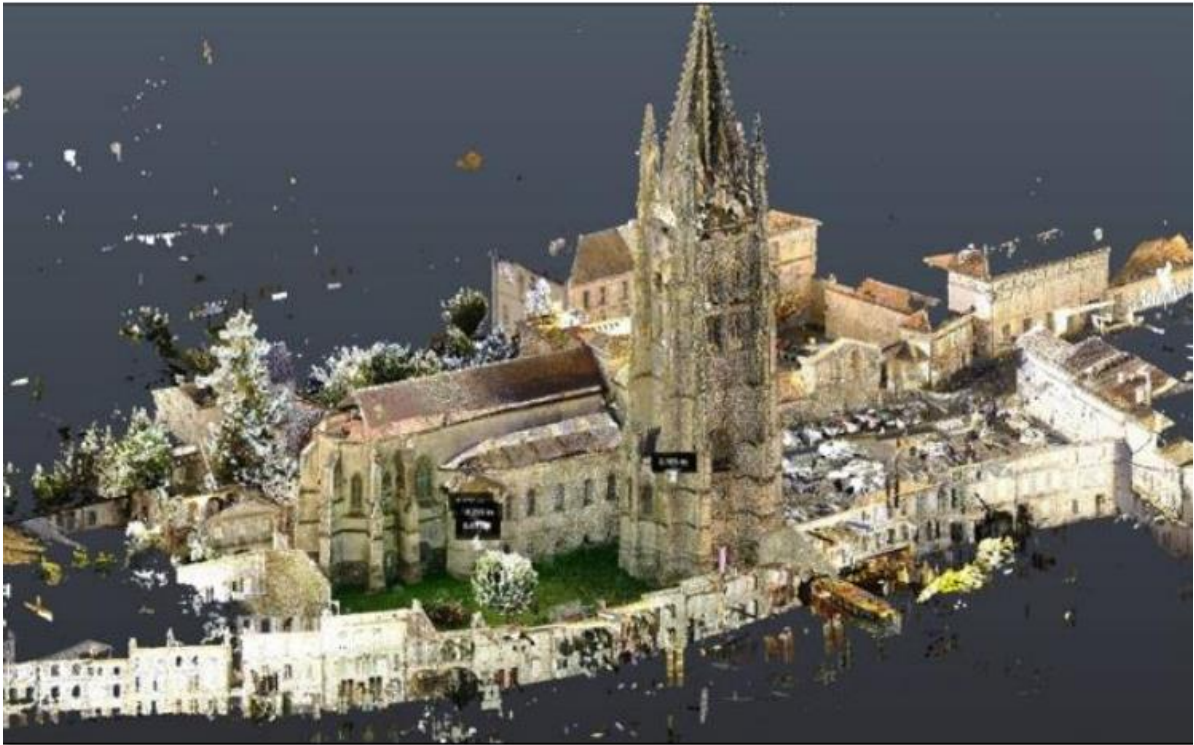
Figure 4 vue en perspective de la basilique Sainte Eutrope - Nuage de points issu d'un relevé par photogrammétrie (Archeovision Prod)
