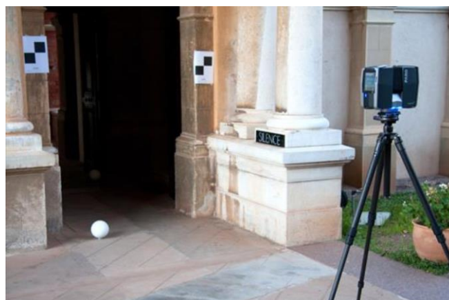
Figure 2 mise en station du scanner Faros Focus, disposition des cibles sphériques et à damiers pour assurer le relevé, la consolidation et le géoréférencement. Monastère St Honorat, Lerins (S. Sorin CEPAM)
