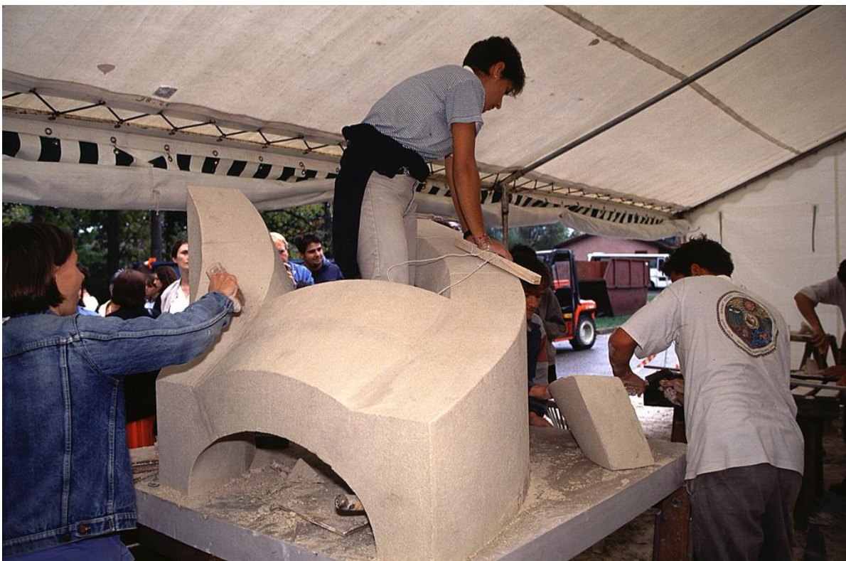
Fig. 1 Lors des Journées d'Automne avec les collègues malheureusement disparus - Joël Sakarovitch et Guy Jouberton -, nous avons tenté la réalisation d'un morceau de Vis de Saint-Gilles en utilisant une vraie pierre (calcaire tendre). Avec des étudiants inexpérimentés en géométrie descriptive et en stéréotomie et sur une durée aussi courte (4 jours), c'était un défi risqué. Finalement, avec un encadrement rapproché, les étudiants se sont passionnés: nous avons même rapporté cette œuvre pour l'exposer à l'Ensal.
