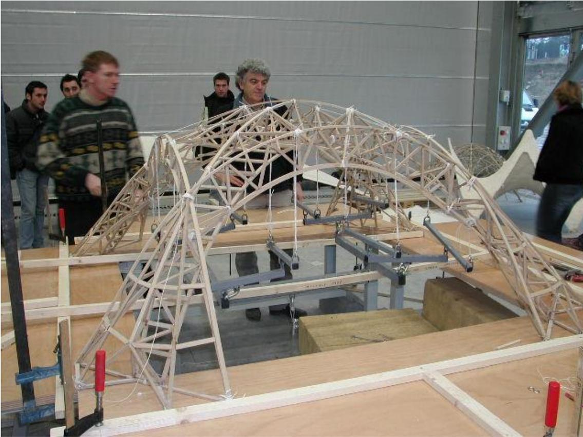
*Fig. 6: Le bon angle de vue de cette photo permet de comprendre le banc d'expérimentation et le système d'accroche en 16 points à la maquette. En parallèle à cet exercice, d'autres équipes réalisaient des structures encore plus grandes (en barres et nœuds ou des coques en staff).*
