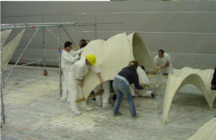
*Fig. 9, 10 et 11: Structures en "coque" réalisées en stuc (de plâtre) et prêtes à être testées. Ces recherches et expérimentations avaient fait l'objet d'une importante préparation (et formation) avec la collaboration d'une entreprise de staff et stuc de Vaulx-en-Velin. (SARL Marquez)*
