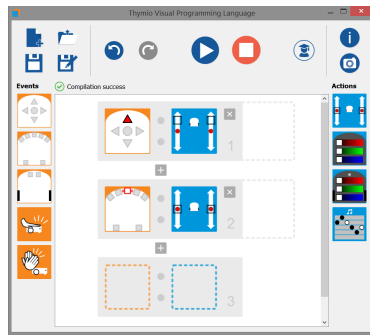
FIGURE 1. Thymio AsebaVPL interface, propose de manipuler deux types de cartes (cartes capteurs et effecteurs) à associer via le formalisme Si... Alors... sur la zone de script centrale
